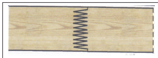
Слика 3.14. Состав со машински запци
